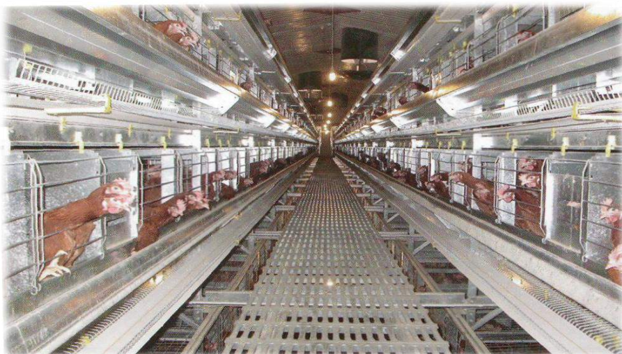
Рисунок 1. Кліткова батарея 6-ярусна фірми Valli для багатопверхових пташників
