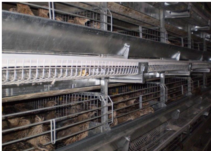
Рис. 2. Кліткова батарея для вирощування перепелів ОКП
