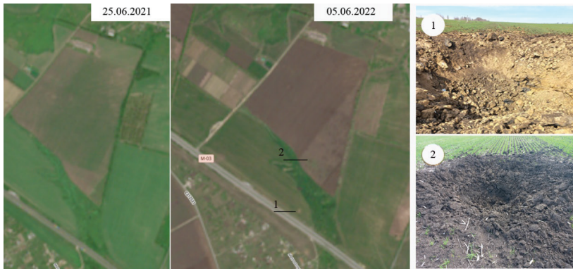
Рис. 2. Супутникові знімки, результати польової перевірки кратерів
