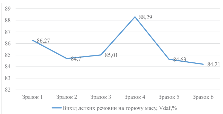
Рис. 3. Вихід летких речовин на горючу масу паливних гранул, V_{daf}, \%
