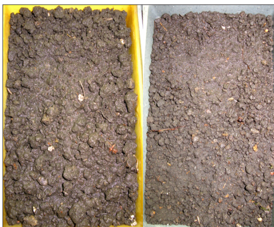
Рис. 4. Зразки ґрунту у ростильнях різного структурно-агрегатного стану для визначення лабораторної схожості насіння редьки олійної після зволоження імітуючим дощуванням
